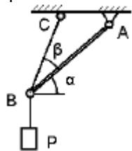
2. Груз весом  $P = 10 \text{ Н}$  подвешен на двух тросах АВ и ВС, составляющих с горизонтальной прямой углы  $\beta=15^\circ$  и  $\alpha=30^\circ$ . Определить усилия в тросах.
